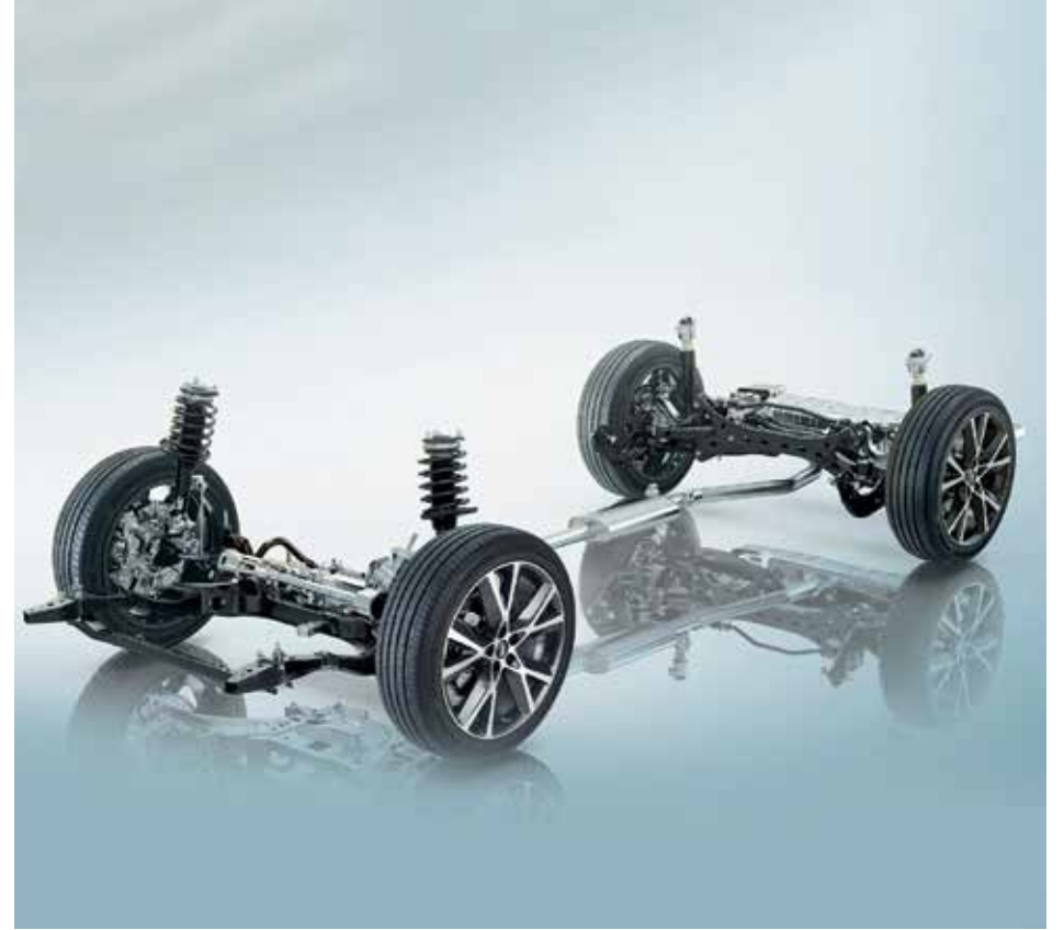
نظام التعليق الأمامي المستقل من McPherson + التعليق الخلفي متعدد الوصلات المستقل McPherson Independent Front Suspension+Independent Multi-link Rear Suspension
